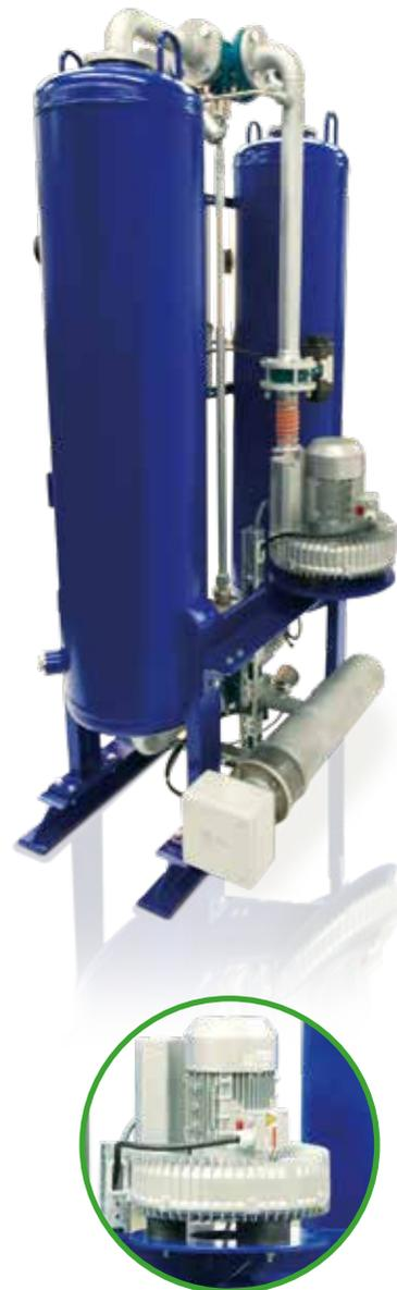
Vakuumbelüftung auf Werkbankhöhe für einfachen Service
